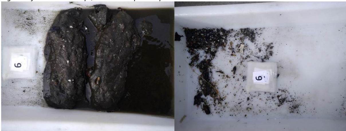
Figur 11: Bilder som viser sedimentet fra stasjon 6 før og etter siling. Sedimentet besto av silt, sand og grus. Foto: Aqua Kompetanse AS.
