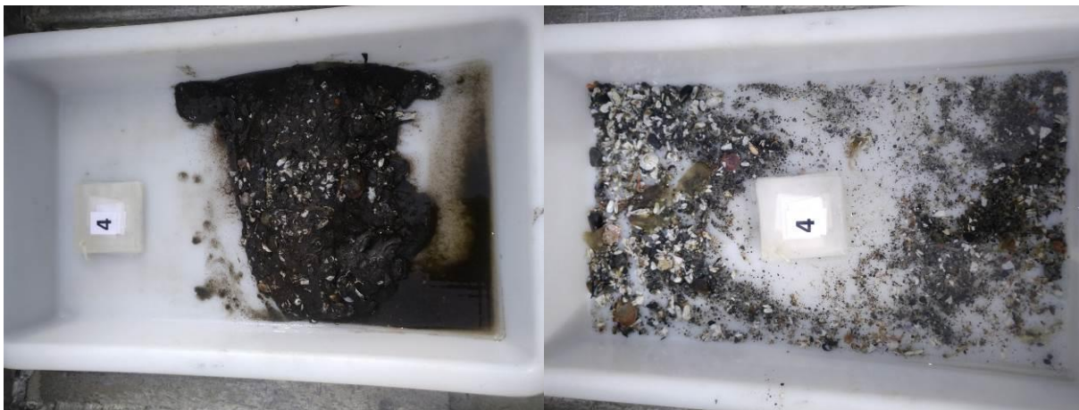
Figur 9: Bilder som viser sedimentet fra stasjon 4 før og etter siling. Sedimentet besto av silt, sand og grus. Foto: Aqua Kompetanse AS.
