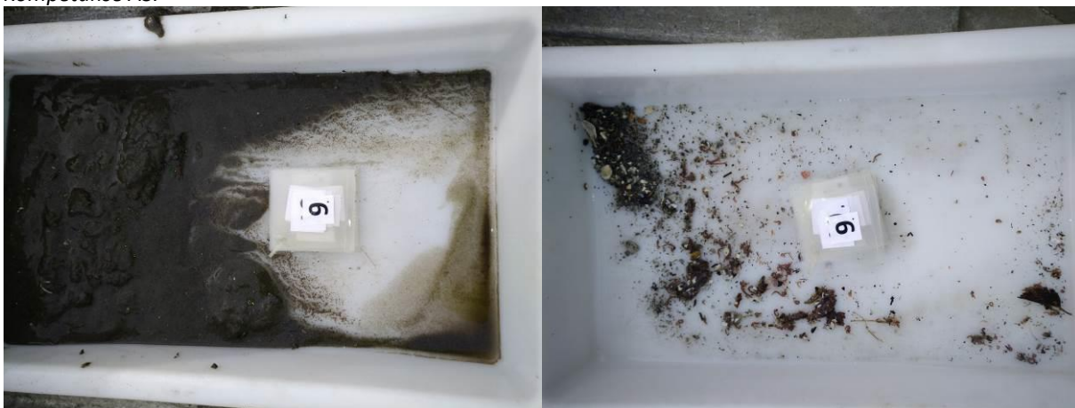
Figur 14: Bilder som viser sedimentet fra stasjon 9 før og etter siling. Sedimentet besto av silt, sand og grus. Foto: Aqua Kompetanse AS.
