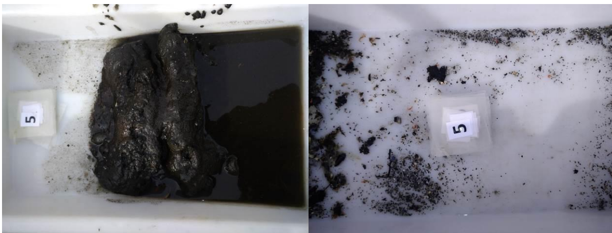
Figur 10: Bilder som viser sedimentet fra stasjon 5 før og etter siling. Sedimentet besto av silt, sand og grus. Det ble registrert fôrrester i denne prøven. Foto: Aqua Kompetanse AS.
