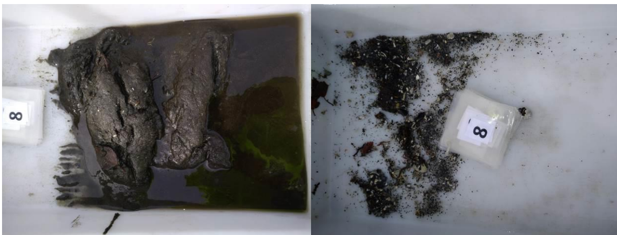
Figur 13: Bilder som viser sedimentet fra stasjon 8 før og etter siling. Sedimentet besto av silt, sand og grus. Foto: Aqua Kompetanse AS.
