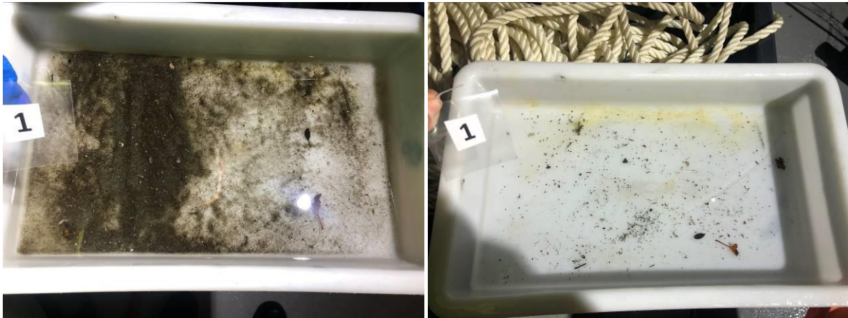
Figur 6: Bilder som viser sedimentet fra stasjon 1 før og etter siling. Sedimentet besto av silt på fjellbunn. Foto: Aqua Kompetanse AS.
